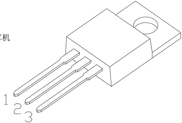
1 基极(B) 2 集电极(C) 3 发射极(E)
