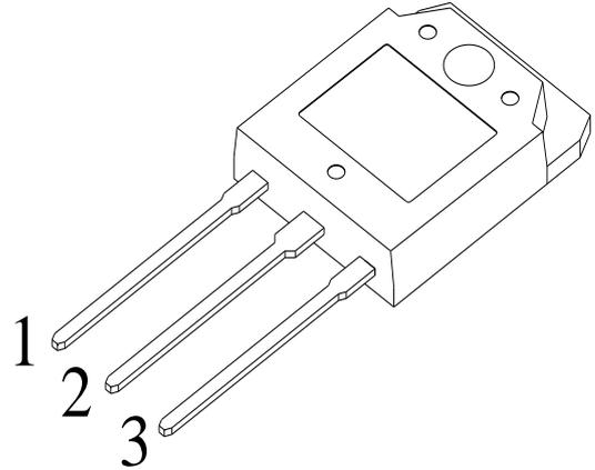
1 基极(B) 2 集电极(C) 3 发射极(E)
